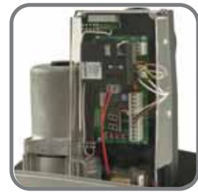
Vor Kablierte Motorsteuerung an Board Built-in control panel
